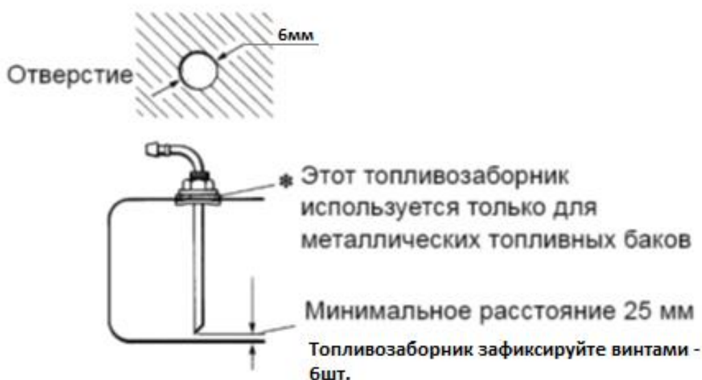
Рис.9 Пример монтажа грузового топливного заборника
